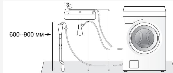
Машина также может быть подключена к стоку с помощью втулочного соединения (сифона). В таком случае шланг также должен находиться на высоте 600-900 мм над уровнем пола. Внутренний диаметр отверстия должен составлять не менее 18 мм.
