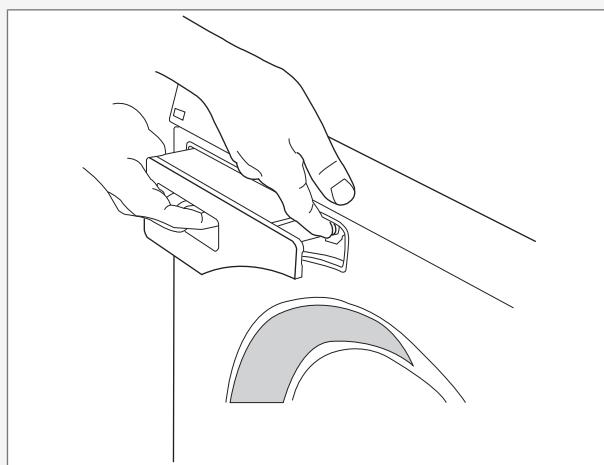
После того как предохранительная защелка, не допускающая открытие отсека детьми, будет активирована, необходимо нажать открывющую кнопку, чтобы выдвинуть отделение для моющего средства.
